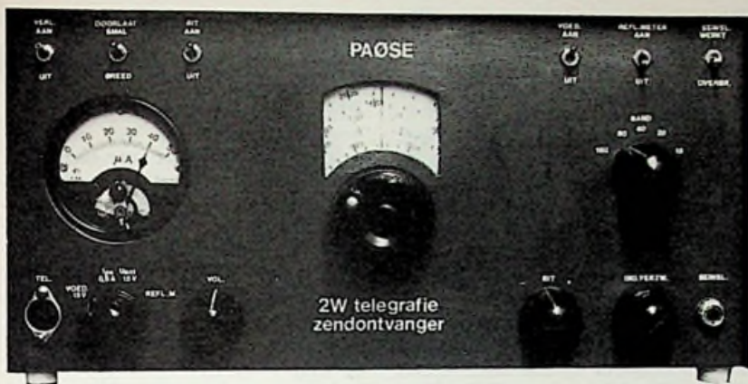
Afb. 8 Door de auteur gemaakte zendontvanger voor telegrafie met klein vermogen (2 W) op een vijftal amateurbanden.
